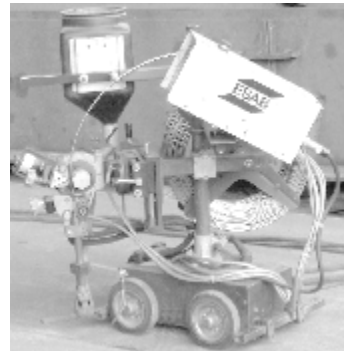
Máy hàn tự động theo phương pháp hàn dưới chất trợ dung
