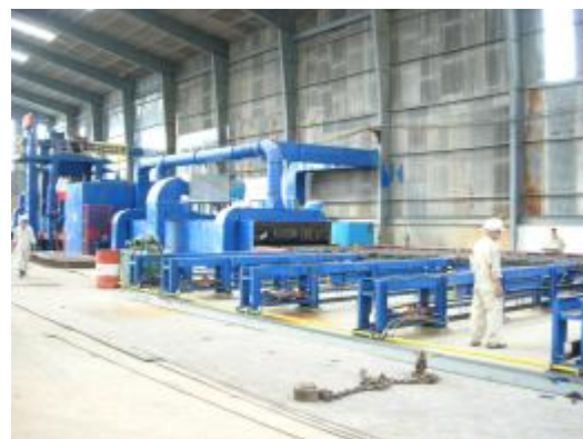
Hình 1.3- Dây chuyền sơ chế tôn
